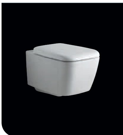
Klozet závěsný s hlubokým splachováním přítok vody zezadu, odtok vodorovný včetně upevňovacího setu T601001 pro skryté upevnění
