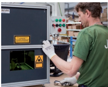
Laser pri procese vypalovania loga.
