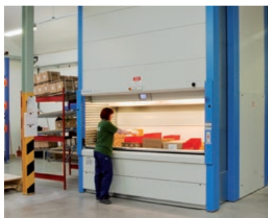
KARDEX. Veľkokapacitný automatizovaný skladovací systém.
