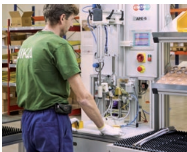
Vzduchový test na montážnej linke.
